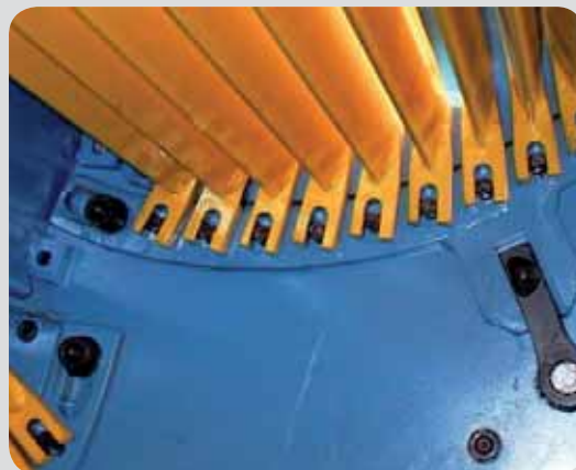
Adjustable contrast grid, to increase or reduce the cleaning action Griglia di contrasto ad angolazione regolabile per aumentare o diminuire l'azione di pulitura Rejilla de contraste de angulación regulable para aumentar o disminuir la acción de limpieza
